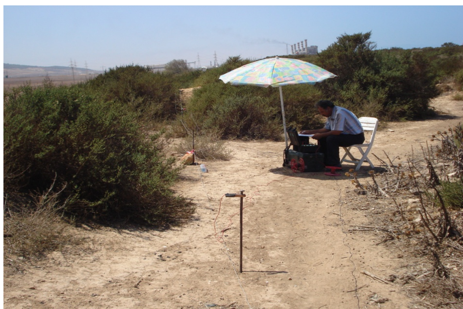
ESSAI DE RESISTIVITE ELCTRIQUE (SEV) USINE D'AMMONIAC ARZEW /MITSUBISHI
