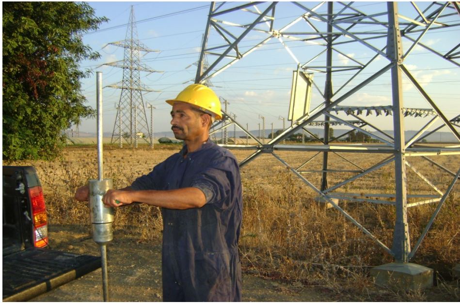
ESSAI AU PENETROMETRE DYNAMIQUE LEGER –LIGNE ELECTRIQUE ALGER
