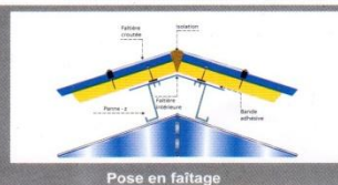
Pose en faîtage
